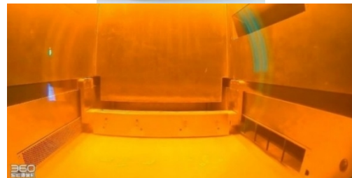
شکل 4- نمایی از دستگاه و محیط پرینت سه بعدی مس.
